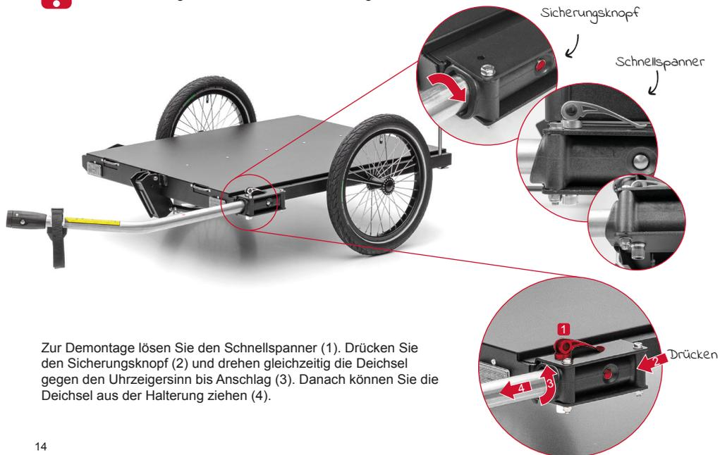
Zur Demontage lösen Sie den Schnellspanner (1). Drücken Sie den Sicherungsknopf (2) und drehen gleichzeitig die Deichsel gegen den Uhrzeigersinn bis Anschlag (3). Danach können Sie die Deichsel aus der Halterung ziehen (4).
