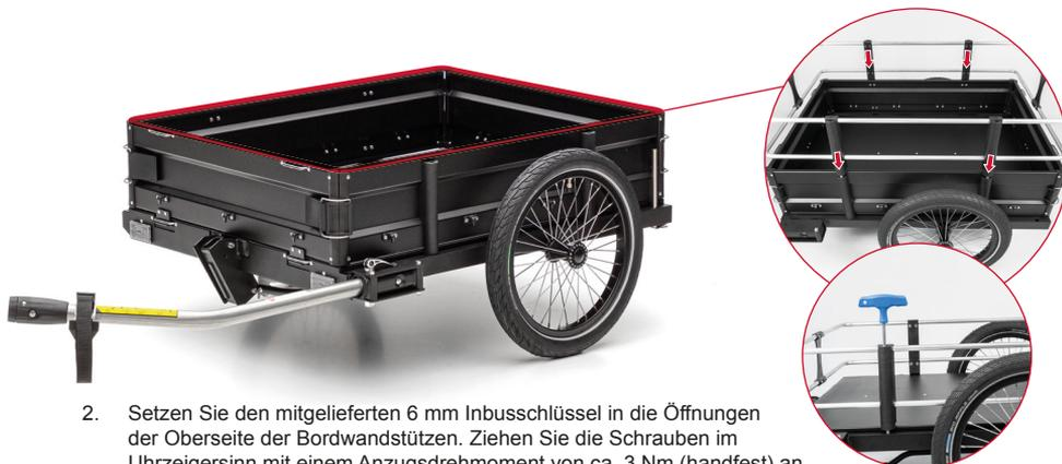
2. Setzen Sie den mitgelieferten 6 mm Inbusschlüssel in die Öffnungen der Oberseite der Bordwandstützen. Ziehen Sie die Schrauben im Uhrzeigersinn mit einem Anzugsdrehmoment von ca. 3 Nm (handfest) an.
